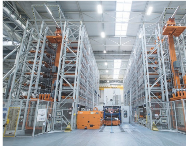
Fahrerlose Transportfahrzeuge liefern Bleche an den Lader der Pressenstraße, wo sie weiterverarbeitet werden.
