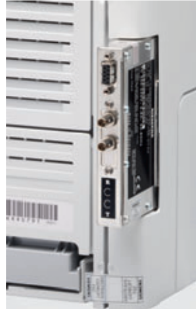
Gefilterte Anschlüsse machen den SITEMP-Drucker abhörsicher.
