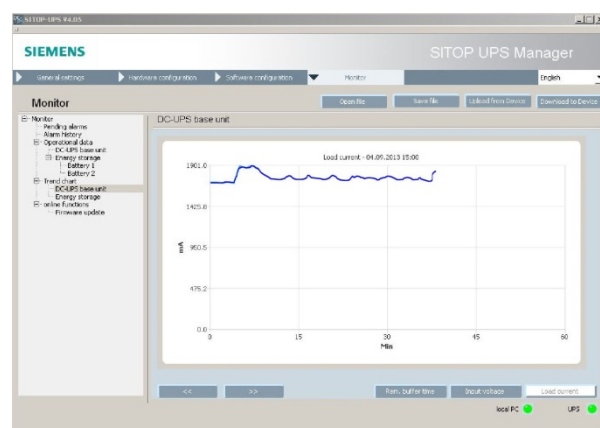
Figura 7: Los distintos diagramas de tendencias del SITOP UPS Manager permiten un diagnóstico amplio del estado de la red y del SAI de DC.
