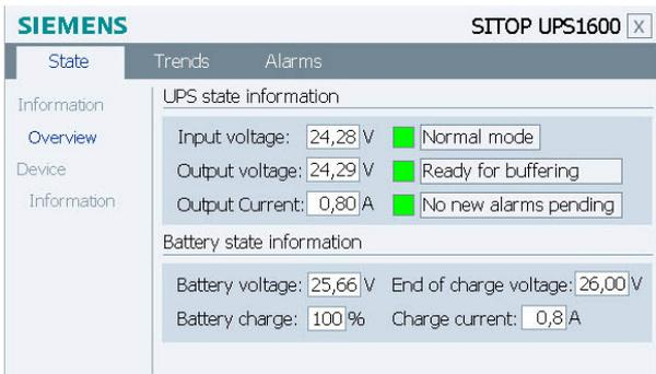
Bild 9: Faceplates für WinCC erleichtern die Visualisierung für umfassende Diagnosen, inkl. Trenddiagramme und Alarmmeldungen
