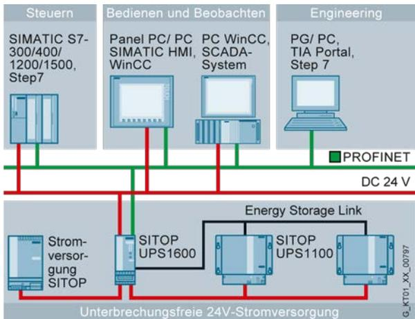
Bild 8: Pufferung einer PROFINET-vernetzten Automatisierungslösung mit SPS. Auch mehrere Steuerungen können unabhängig voneinander in einen definierten Zustand gebracht werden
