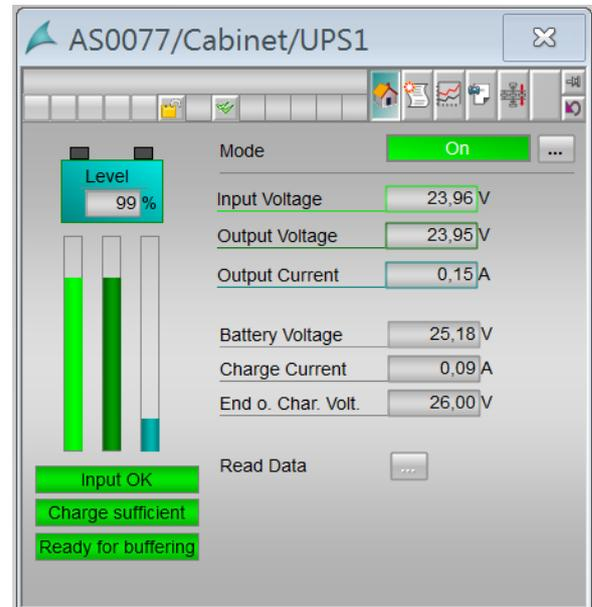
Bild 10: Faceplates für die SIMATIC PCS 7 ermöglichen auch die einfache Diagnose und Wartung der DC-USV in der Prozessindustrie
