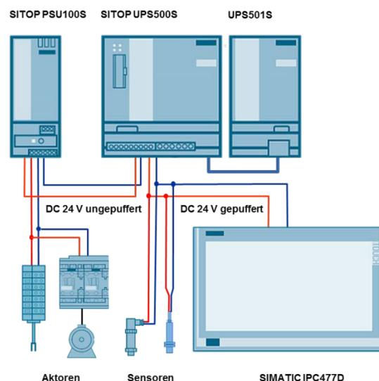
Bild 2: Applikationsbeispiel zur Dimensionierung einer Unterbrechungsfreien 24-V-Stromversorgung
