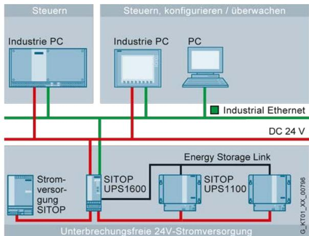
Bild 6: Pufferung mehrerer 24-V-PCs. Die Kommunikation über Industrial Ethernet ermöglicht umfangreiche Diagnosen und bei Netzausfall das gezielte Herunterfahren im Master-Slave-Modul
