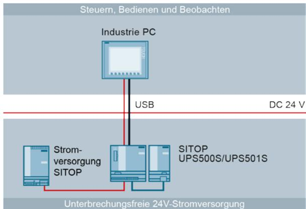
Bild 5: Pufferung von einem 24-V-Automatisierungsrechner mit Kommunikation über USB
