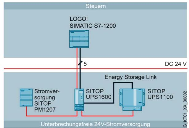
Bild 4: Pufferung einfacher Automatisierungsanwendungen mit Status-Signalisierung über digitale Ausgänge.
