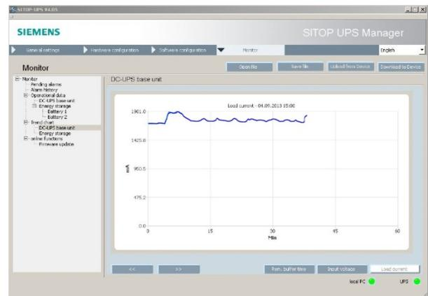
Bild 7: Die verschiedenen Trenddiagramme des SITOP UPS Managers ermöglichen eine umfassende Diagnose über den Zustand des Netzes und der DC-USV.
