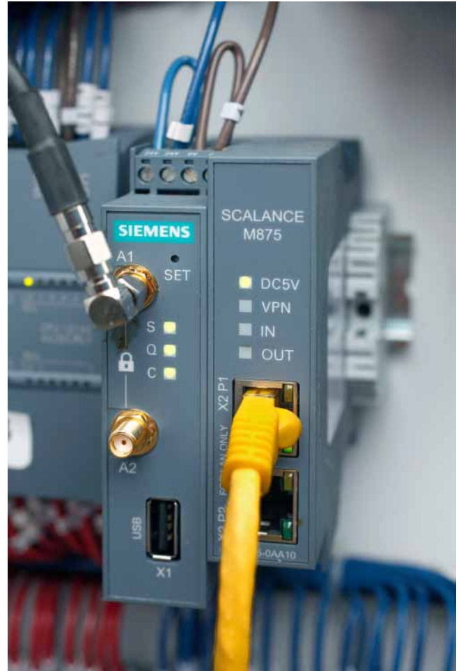
Waste Harmonics setzt auf eine Siemens-Lösung mit dem 3G Mobilfunk-Router SCALANCE M875 und der Steuerung SIMATIC S7-1200.
