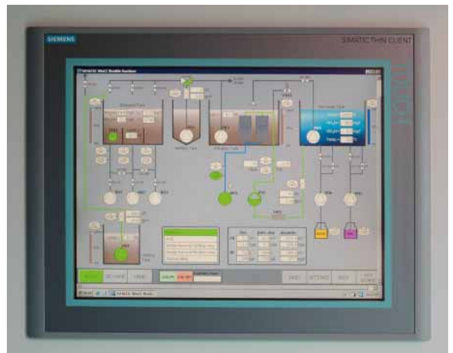
Dank schnellster Funkübertragung via sicherem UMTS-Router lassen sich die Aufbereitungsanlagen auch aus der Ferne wie vor Ort bedienen, beobachten und warten.
