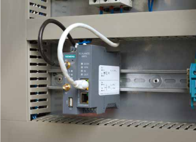
Schnelle und dank Firewall und VPN mit IP-sec sichere WAN-Kommunikation ist ein wesentliches Merkmal des neuen UMTS-Routers SCALANCE M875 von Siemens.
