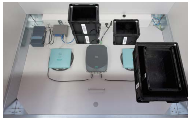
...erfasst ein SIMATIC-Reader RF670R mit zwei abgesetzten UHF-Antennen SIMATIC RF640A die Tag-Daten und überträgt sie vom Kunden an das Würth-Logistikzentrum.
