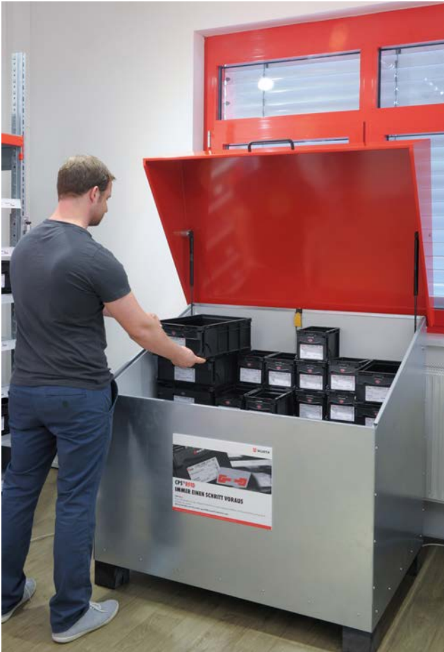
Die RFID-Palettenbox (iBox) ist das Herzstück der Würth-Logistiklösung. Sobald ein Mitarbeiter die leeren Kleinteilebehälter in die iBox stellt und sie schließt...
