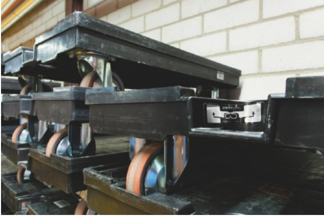
Bild 3: Die RFID-Tags SIMATIC RF630L sind geschützt an rund 190.000 Dolllys angebracht und speichern deren eindeutige Nummer
