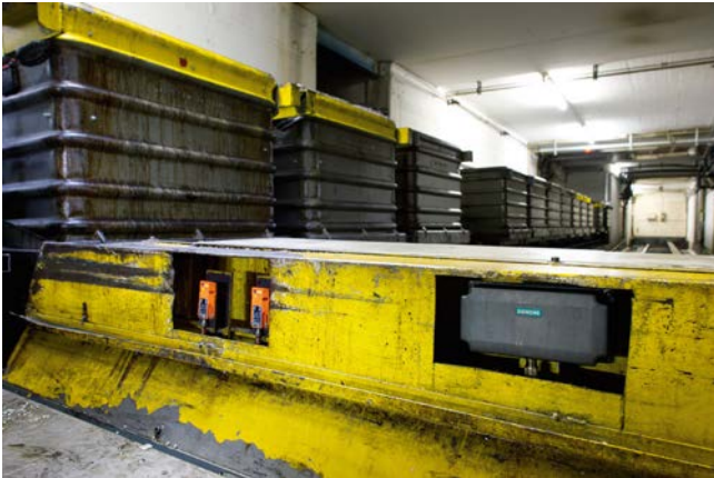
Bild 4: Das RFID-Lesegerät Simatic RF380R erfasst die auf den Transpondern hinterlegten Behälternummern und leitet die Behälter in die richtigen Wege
