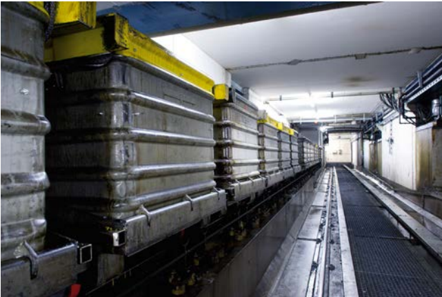
Bild 2: Mit neuer Steuerung und Identifizierung via RFID- (Radio-Frequency-Identification)-Technologie von Siemens hat Mevaco das sortenreine Sammeln von Stanzschrott deutlich flexibler und zukunftssicher gemacht
