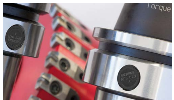
Zur Aufnahme der Datenträger MDS D421 sind im Werkzeug Bohrungen für den bündigen Einbau angebracht. Der Schreib-/Lesebestand beträgt acht Millimeter
