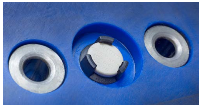
Mit Abstandshaltern in die Werkstückträger eingelassene mobile Datenspeicher MDS D160 ermöglichen die einfache und eindeutige Zuordnung und Nachverfolgung von Montage- und Prüfschritten
