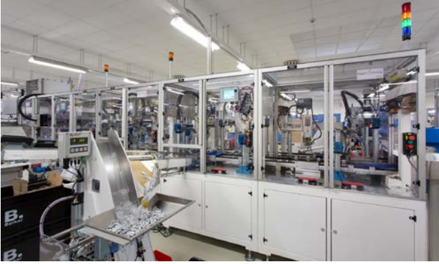
Vom Hager Machinery Department für Berker realisierte, weitgehend automatisch arbeitende Montage- und Prüflinie „Ecoline“ für Kanalsteckdosen
