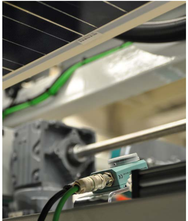
Kompakte und kostengünstige Code-Lesesysteme SIMATIC MV420 von Siemens zur lückenlosen Nachverfolgung und Steuerung des Fertigungsflusses (über Barcode bzw. Data Matrix Code)
